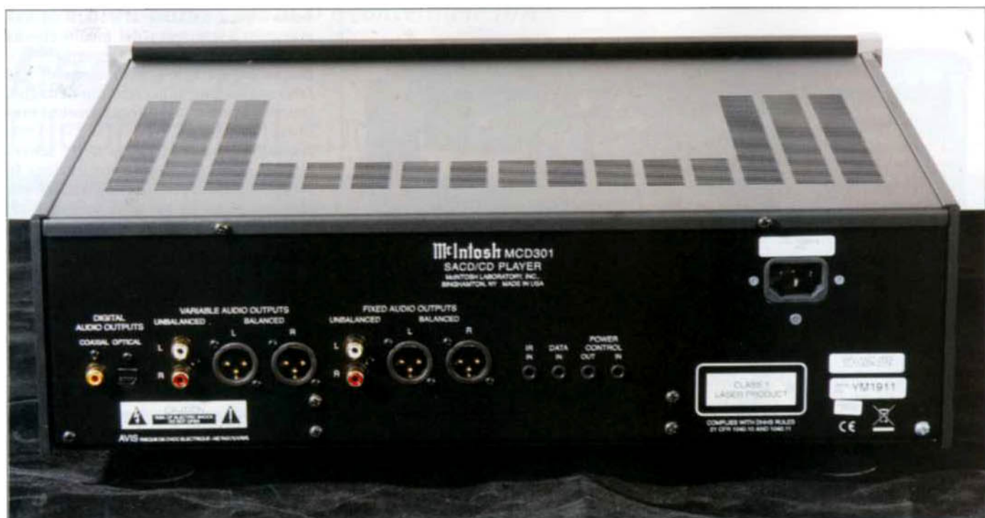
Uscite digitali RCA e ottica, uscite analogiche (variabili e fisse separate, giustamente) RCA e XLR.
